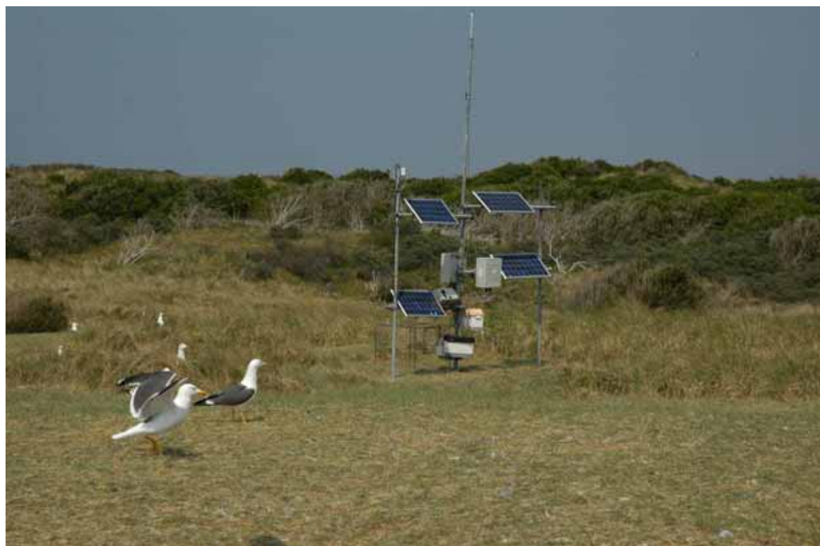
Grondstation in de Kelderhuispolder voor de geautomatiseerde ontvangst van GPS-logger gegevens (CJ Camphuysen)
