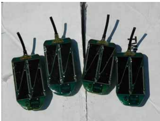
GPS loggers, opladend in de zon, kort voor het aanbrengen (CJ Camphuysen)
